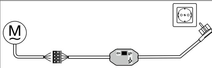
Verbinden Sie die Anschlusslitzen des Rohrantriebes farben-
