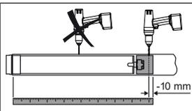
Para asegurar una transmisión segura del momento de torsión en **ejes cilíndricos**, recomendamos atornillar la rueda motriz con el eje (ver la tabla siguiente).
