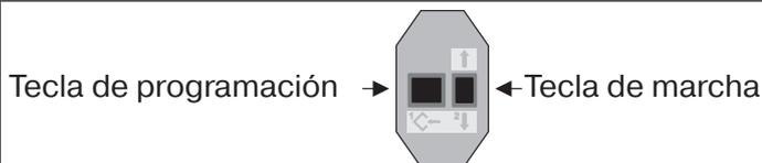
Empalme los hilos de conexión del automatismo tubular con los hilos del mismo color del set de ajuste para automatismos con desconexión final electrónica y conecte la tensión de red.
