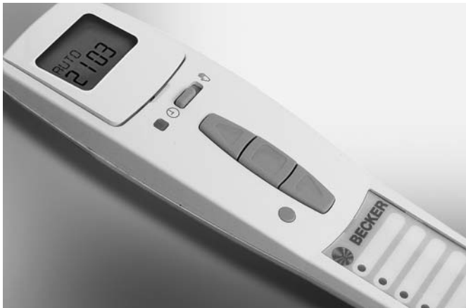
5-Kanal Handsender mit integrierter Zeitschaltuhr zur Einzel- und Gruppensteuerung von Funkantrieben und Funkempfängern
